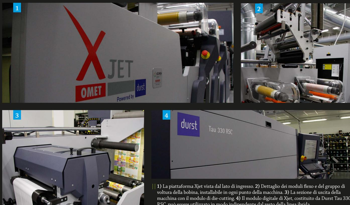
1) La piattaforma Xjet vista dal lato di ingresso. 2) Dettaglio dei moduli flexo e del gruppo di voltura della bobina, installabile in ogni punto della macchina. 3) La sezione di uscita della macchina con il modulo di die-cutting. 4) Il modulo digitale di Xjet, costituito da Durst Tau 330 RSC, può essere utilizzato in modo indipendente dal resto della linea ibrida.
